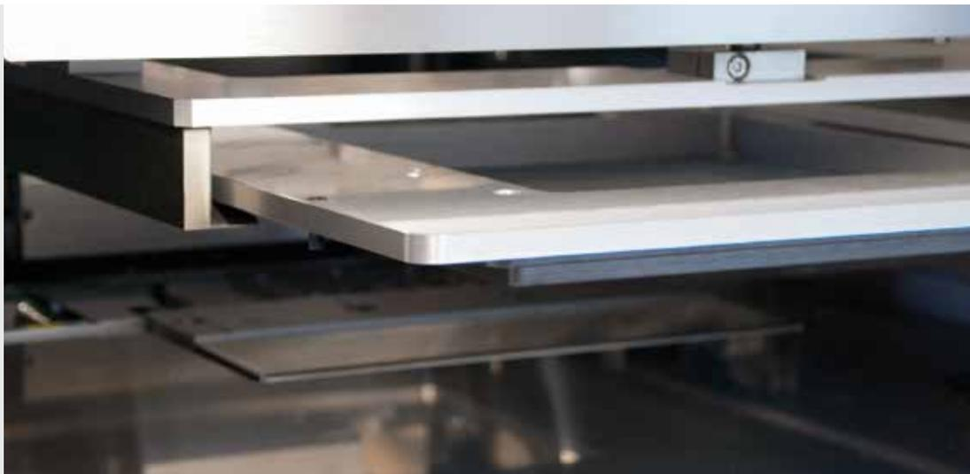
Schnellspannsystem / *Quick-clamp system*
