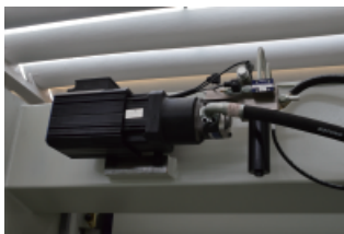
伺服主电机， 油电混合系统，折弯精度更高
